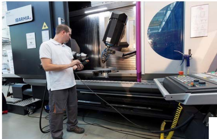
La máquina incorpora las tecnologías de adición por láser y permite también el fresado y torneado de piezas a gran escala
